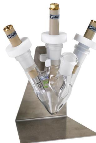
锂离子电池材料测试电解池工具包为测试电池材料与电解质而设计的各种电解池。采用气密密封设计为在手套箱里外进行实验提供技术保障。
