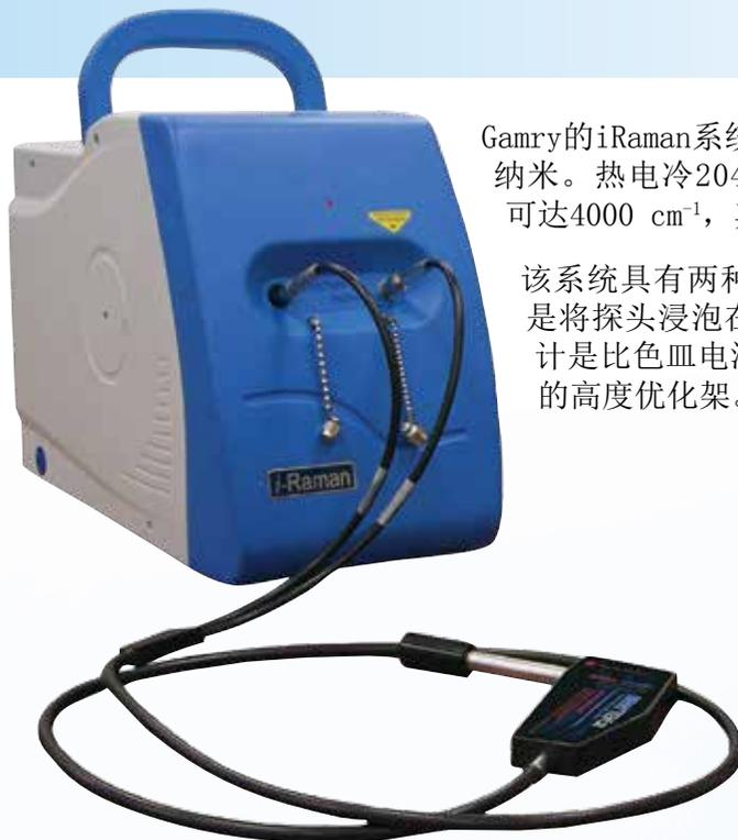
Gamry的iRaman系统由两个激光选项 - 532或785 纳米。热电冷2048像素CCD为拉曼位移覆盖范围 可达4000  $\text{cm}^{-1}$ ，其分辨率为3  $\text{cm}^{-1}$ 。
