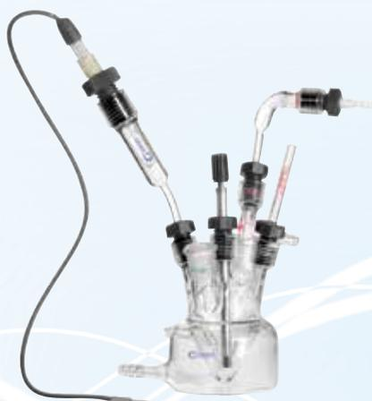
工作电极可以采用铂金，碳（玻或光纤）和黄金等。他们可以是直径大于3mm的大电极或直径10微米的微电极。
