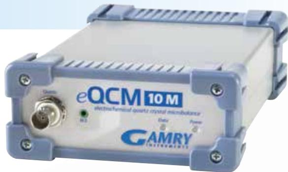
eQCM 10M是一种兼容性很好的仪器，可以和1-10MHz的任何晶片、任何电解池相兼容。它的质量检测分辨率可以达到 $\text{ng}/\text{cm}^2$ 的变化，这是小于单层材料的质量变化。谐振器软件可以同时控制eQCM 10M和Gamry恒电位。
